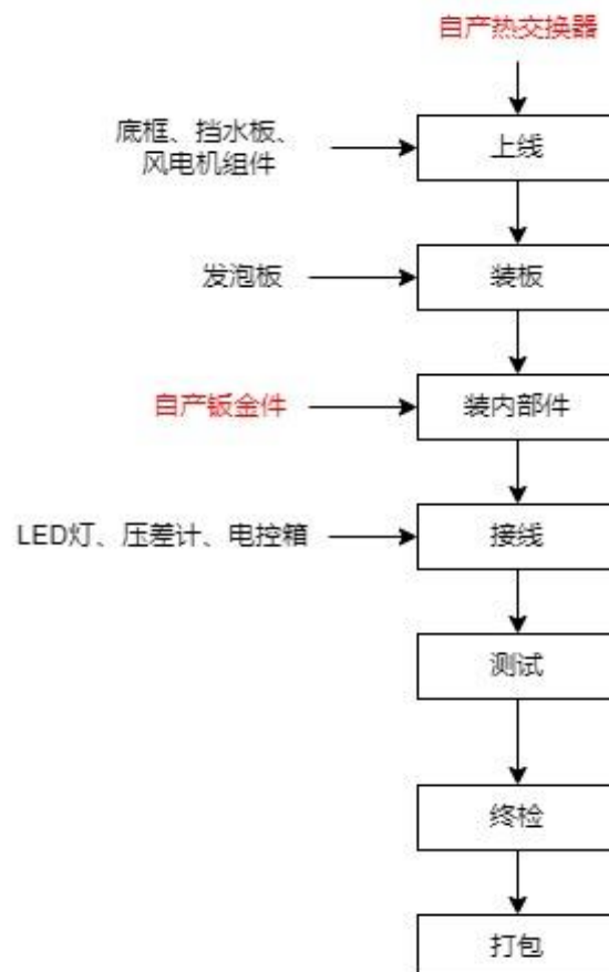
图 2-4 空气处理机组生产工艺流程图
